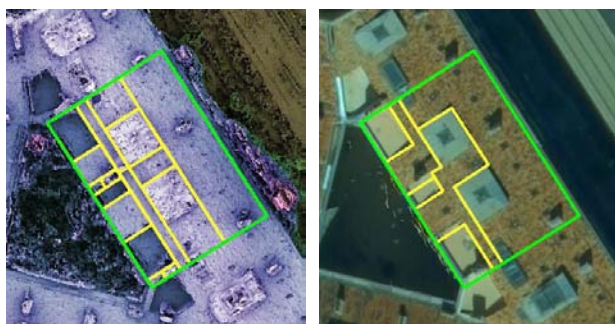
(a) MNE et résultat de la découpe (b) Orthophotographie et résultat de la fusion
