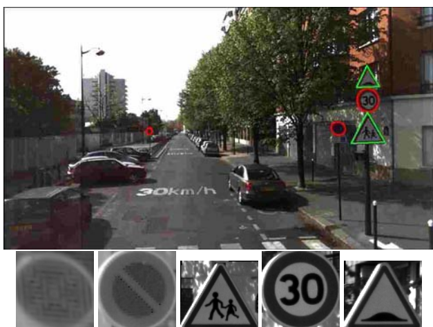
FIG. 11 – Résultat de détection de différents types de panneaux et les images rectifiées correspondantes.
