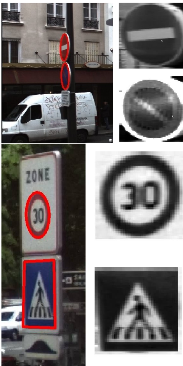
FIG. 7 – Rectification de panneaux dans le cas de déformations perspectives très forte.
