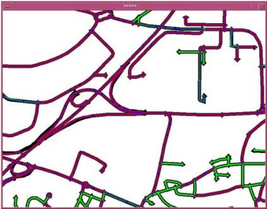
Figure 4.6 - Illustration des décalages de géométrie entre versions à jour de la BDTopo25
