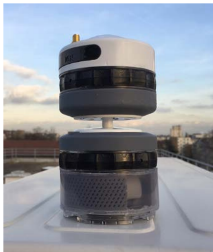
Prototype du nouveau Géocube doté d'une couche anémomètre à ultrasons et d'une couche batterie.
