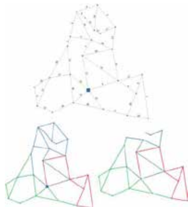
Réseau routier étudié et deux solutions de tournées de véhicules. Dans le deuxième cas, certaines voies sont submergées.
