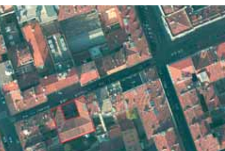
Ortho-découpe : la découpe (manuelle) d'une parcelle si celle-ci ne correspond pas à la forme 3D.
