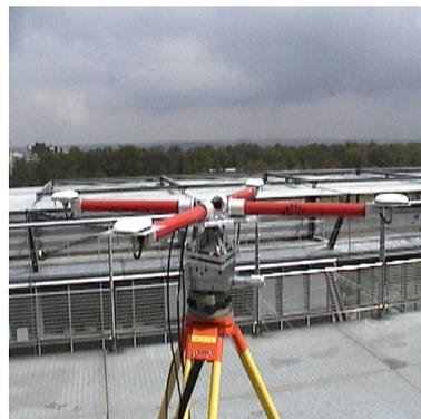
Fig. 1. Photographie du tétraèdre des accéléromètres. Fig. 2. Vue des quatre antennes du récepteur GPS
